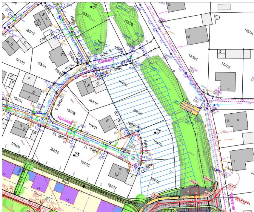
Abbildung 25: Regenrückhaltebecken am Kohlstatt/Weidener Straße
